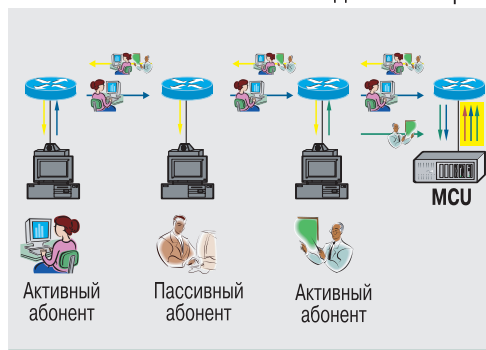
Рис. 2. Проведение видеоконференции с использованием «Видеоселектора»
