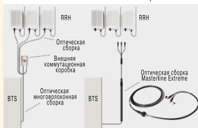
Рис. 5. а) Оптический тракт с промежуточной точкой коммутации; б) пример использования многоволоконной сборки ML Extreme
