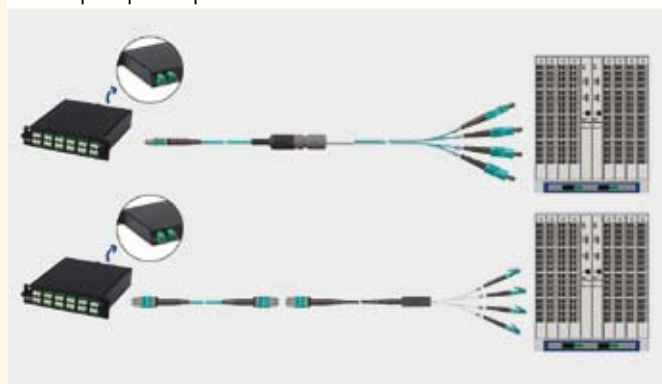
Рис. 2. Варианты подключения коммутаторов SAN с помощью претерминированных кабельных систем высокой емкости
