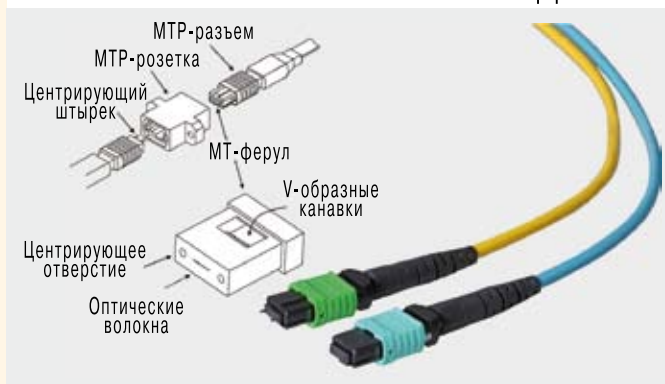
Рис. 1. Кабельные системы высокой емкости на основе оптического интерфейса MTP
