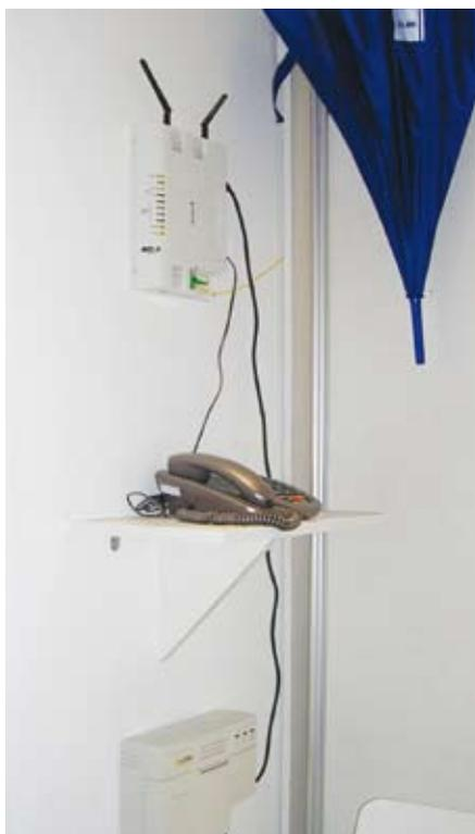
разъемами RJ-11 для подключения телефонов, антенным RF-выходом и модулем Wi-Fi, а также ИБП, который обеспечит работу телефона при перебоях электропитания.
