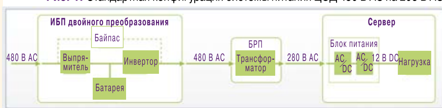
Рис. 1. Стандартная конфигурация системы питания ЦОД 480 В АС на 208 В АС
