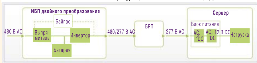
Рис. 3. Конфигурация системы питания ЦОДа 480/277 В AC
