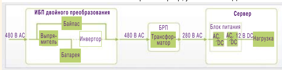
Рис. 2. В экономичном режиме поступающий ток не проходит через инвертор, увеличивая КПД системы ИБП
