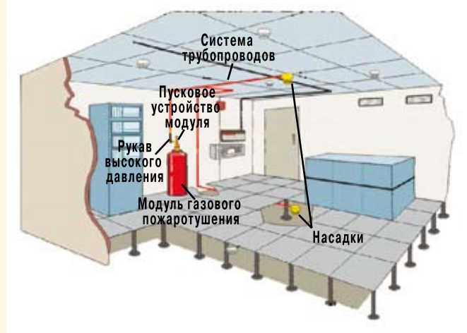
Рис. 2. Технологическая часть установки газового пожаротушения
