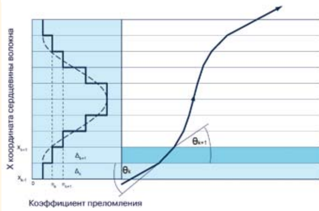
Рис. 1. Кусочно-линейная аппроксимация траектории луча в многомодовом волокне с градиентным профилем преломления
