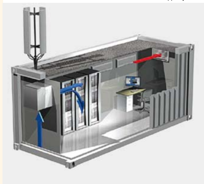
Рис. 3. Система на основе фрикулинга
