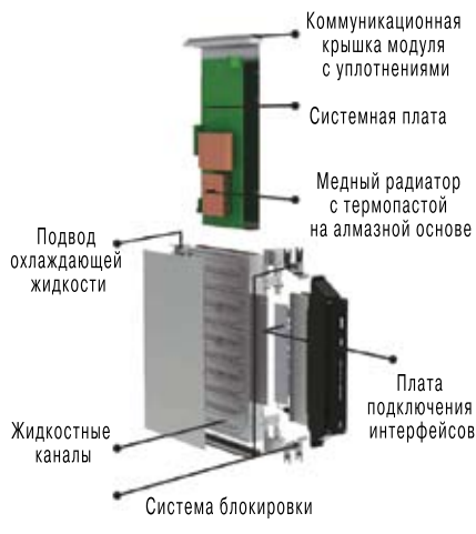
Рис. 6. Жидкость-диэлектрик отводит тепло через стенку емкости, в которую погружен сервер
