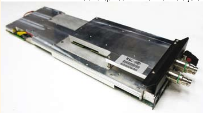
Рис. 5. Охлаждающая пластина покрывает всю поверхность вычислительного узла
