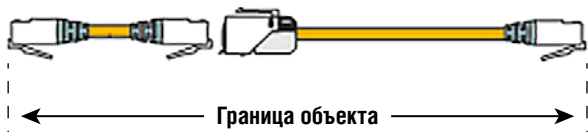
Рис. 1. Структура тракта в случае применения концепции прямого подключения
