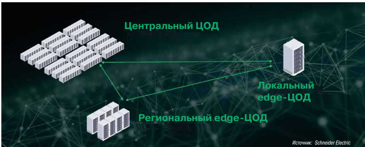
◀ Рис. 3. Архитектура распределенной сети ЦОДов, предлагаемая Schneider Electric
