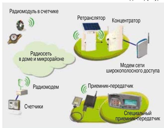
Рис. 3. Организация беспроводной внутридомовой технологической инфраструктуры
