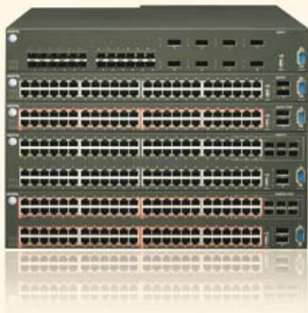
Коммутаторы серии ERS5600 фирмы Nortel позволяют создавать «коммутирующий кластер» благодаря 120-гигабитной стекирующей шине
