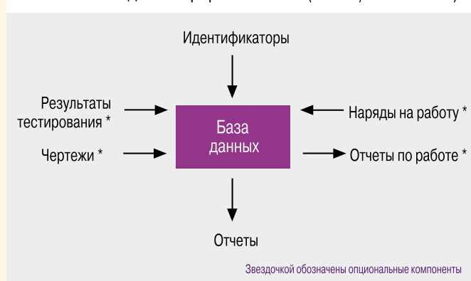
Рис. 1. База данных как центральный элемент системы администрирования СКС (по ISO/IEC 14763-1)
