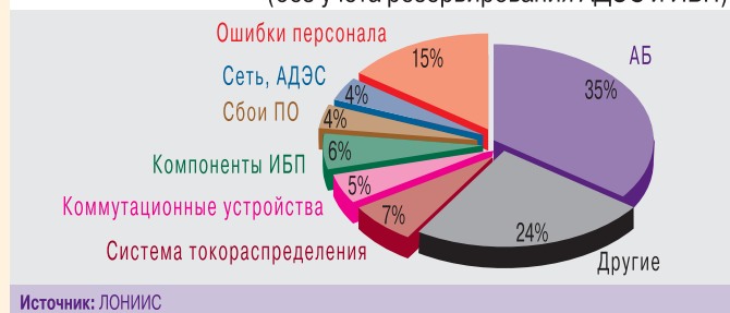
Рис. 1. Причины пропадания напряжения на выходе ИБП (без учета резервирования АДЭС и ИБП)
