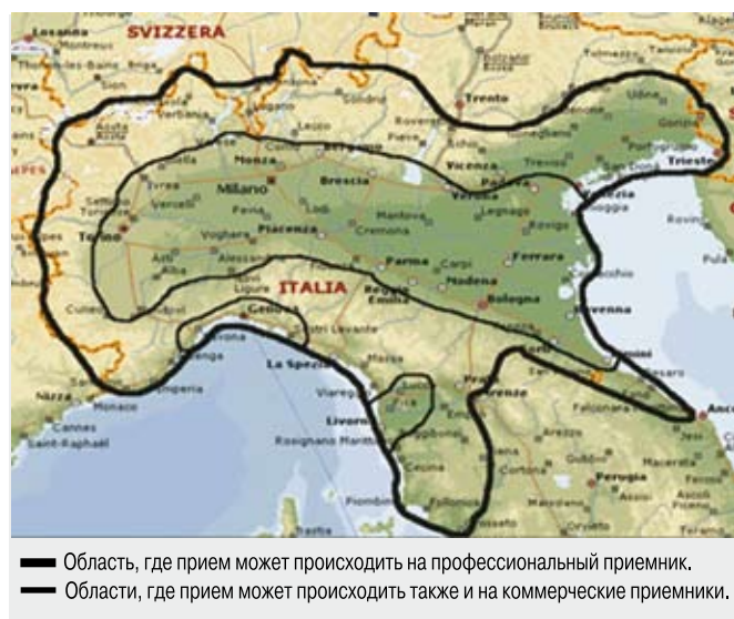
Рис. 2. Зоны приема сигнала DRM на профессиональный и бытовой приемники
