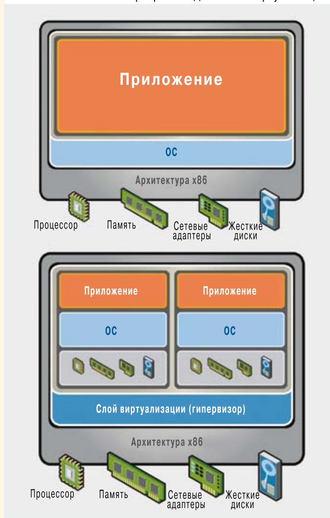
Рис. 1. Структура программно-аппаратных средств серверов x86 до и после виртуализации
