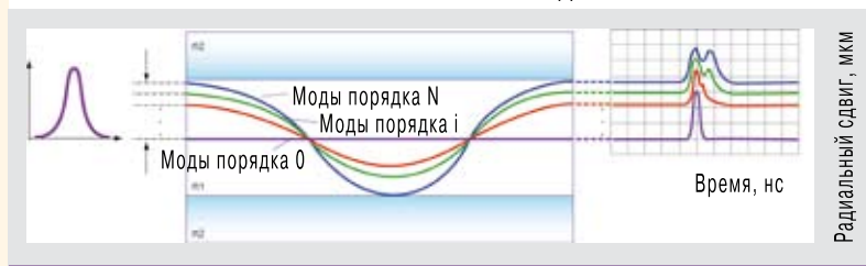
Рис. 6. Измерение дифференциальной модовой задержки в многомодовом оптическом волокне
