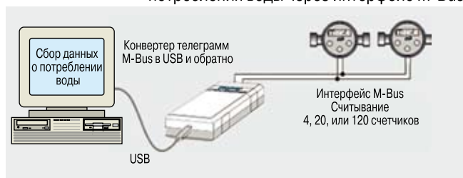
Рис. 4. Схема сбора данных со счетчиков потребления воды через интерфейс M-Bus
