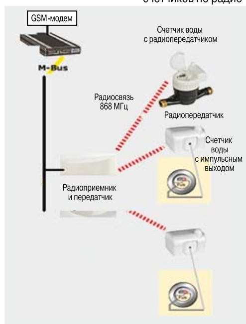
Рис. 5. Схема сбора показаний счетчиков по радио
