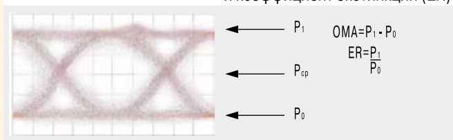
Рис. 1. Амплитуда оптической модуляции (ОМА) и коэффициент экстинкции (ER)
