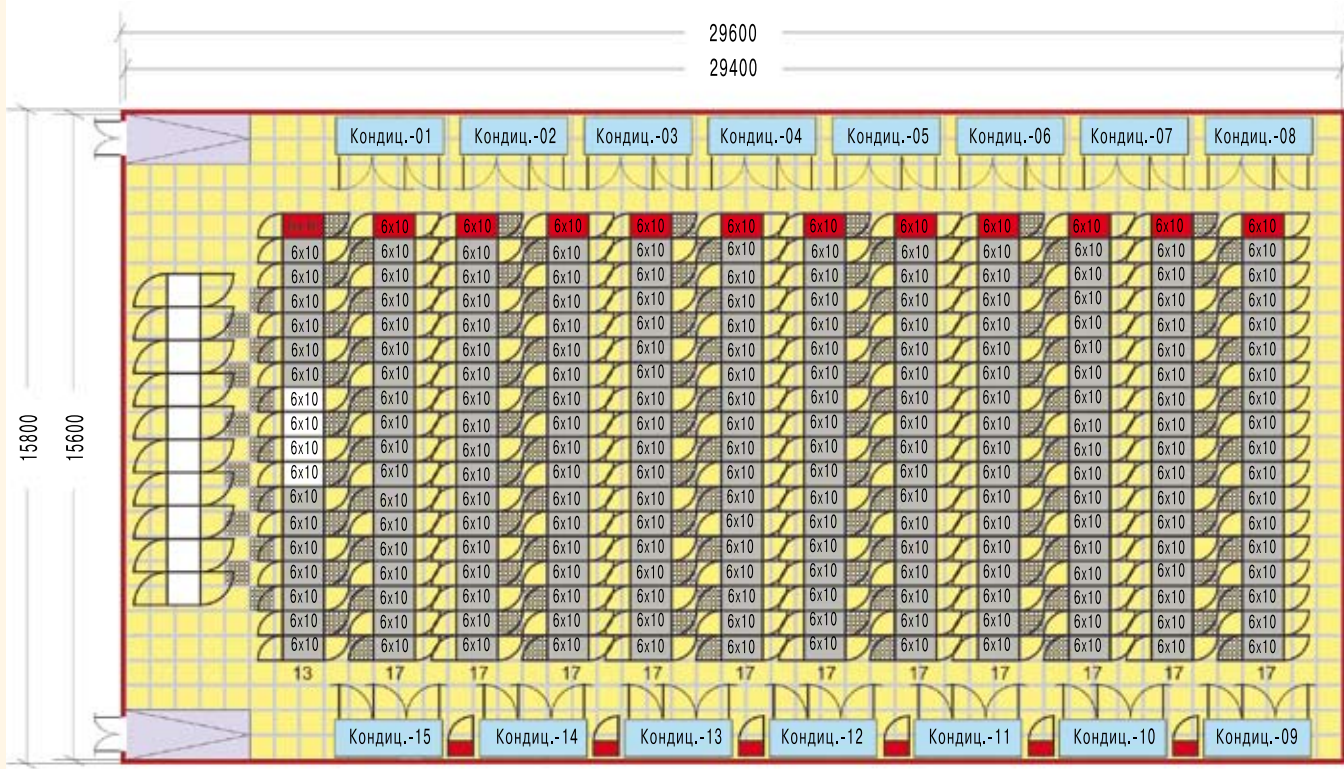
Рис. 1. Вариант 1: ЦОД из 200 стоек – 5 кВт на стойку
