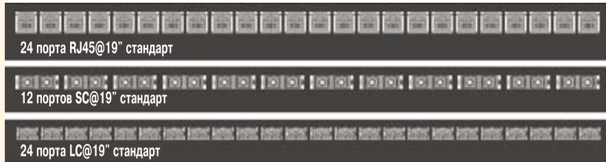
Рис. 1. Интерфейс LC: двукратное увеличение плотности монтажа в сравнении с оптическим интерфейсом SC
