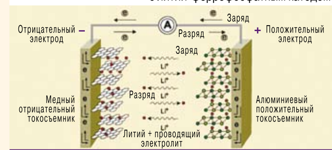
Рис. 2. Устройство литий-ионного аккумулятора с литий-феррофосфатным катодом
