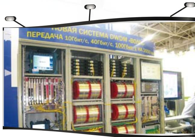
Второй рекорд – передача 80 каналов 100G на сверхдлинные расстояния (до 4 тыс. км) без компенсаторов дисперсии в каскаде усилителей. Максимальная емкость 80-канальной DWDM-системы составляет 8 Тбит/с. Как заявляет производитель, транспондер 100 Гбит/с «Волга» имеет лучшие в отрасли параметры качества сигнала 100 Гбит/с и величину электронной компенсации дисперсии. На стенде была показана передача сигнала 100G на 2000 км под контролем системы управления «Монитор», также разработанной «T8».
