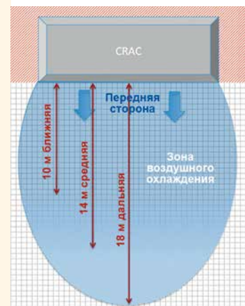
Рис. 3. Зоны охлаждения холодным воздухом, подаваемым CRAC из-под фальшпола
