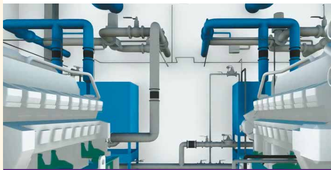
Рис. 4. Анализ коллизий взаимного расположения инженерного оборудования в ЦОДе на базе BIM-модели
