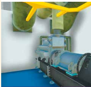
Рис. 2. Фрагмент BIM-модели с низкой степенью детализации
