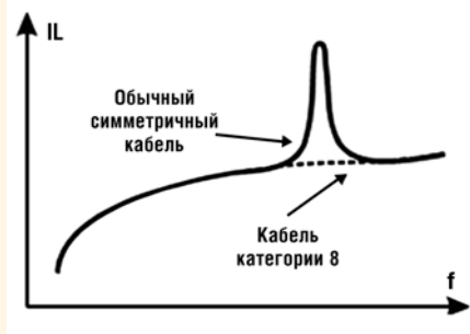
Рис. 2. Частотная характеристика рабочего затухания различных видов кабелей
