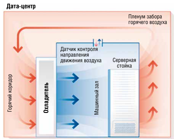
Рис. 2. Принципиальное расположение датчика, фиксирующего направление движения потока воздуха
