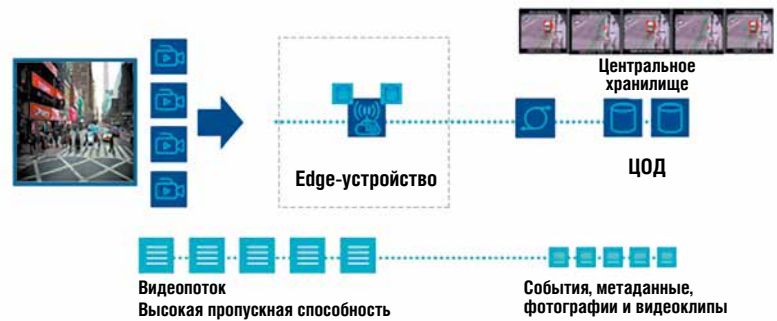
Рис. 5. Обработка получаемых с видеокamer видеопотоков с использованием Edge-устройств
