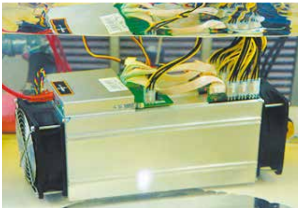
Рис. 1. «Асик», погруженный в охлаждающую жидкость
