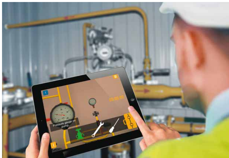
▲ Рис. 3. AR-приложение для отработки последовательности операций при переключении режимов газораспределительного оборудования
