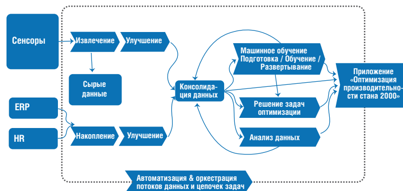
Рис. 1. Жизненный цикл данных металлургического производства
