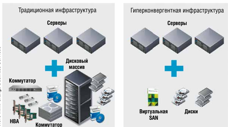
Рис. 4. Традиционная и гиперконвергентная ИТ-инфраструктура
