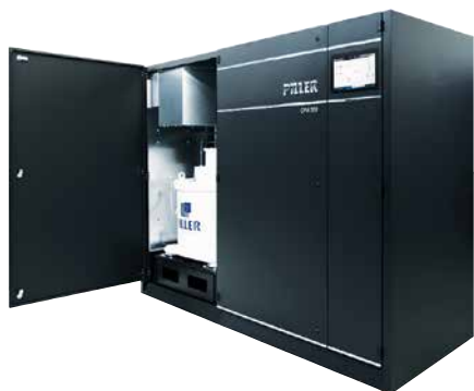
▲ ДИБП CRM300 (300 кВт/333 кВА) построен как ИБП с двойным преобразованием на базе IGBT-транзисторов, но использует кинетический накопитель вместо АКБ
