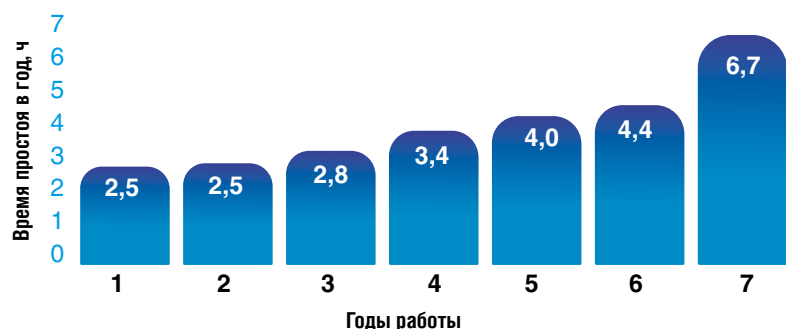
Рис. 6. Рост времени незапланированного простоя на протяжении срока эксплуатации серверов
