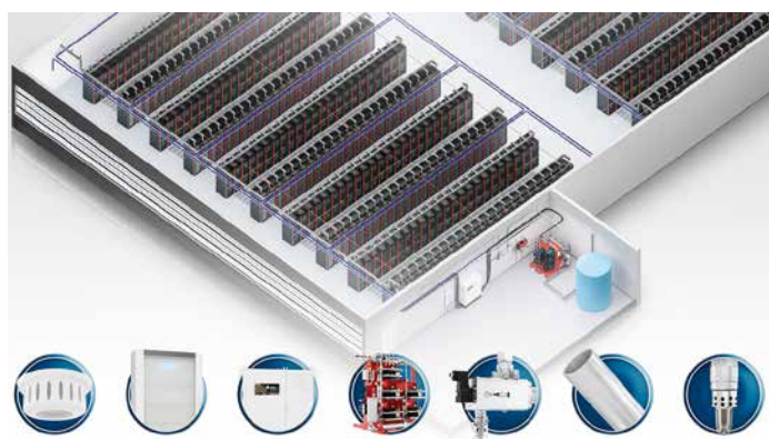
▲ Основные элементы и структура установки HI-FOG®
