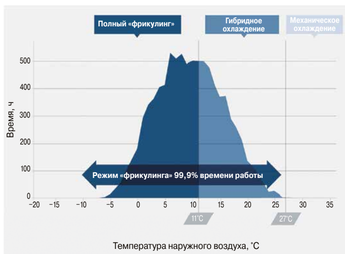
▲ Рис. 2. Использование режима «фрикулинга»
