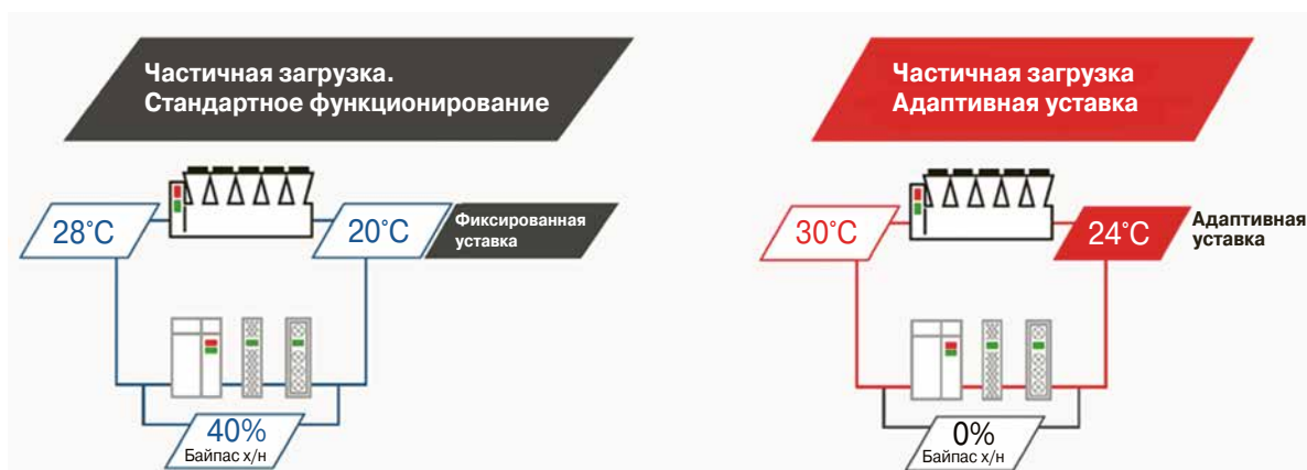
Рис. 5. Принцип работы адаптивной уставки при частичной нагрузке ▼
