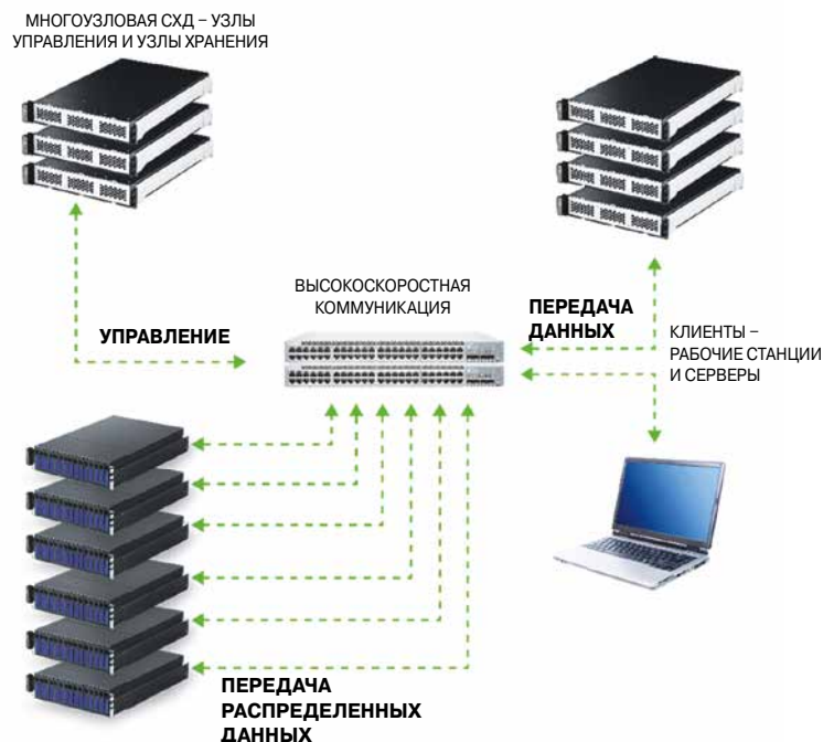
Структура СХД Bitblaze SIRIUS 8000 от компании «Промобит» ▼
