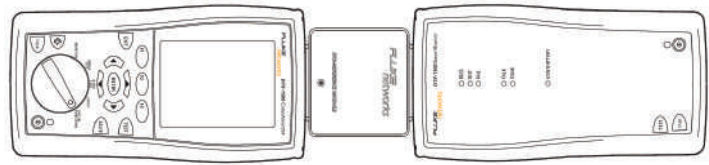
▲ Рис. 1. Подключение модулей прибора DTX-ELT друг к другу через адаптер для установки эталонного значения перед началом работы
