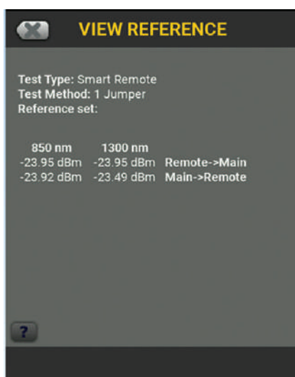
Рис. 6. Установка эталонного значения на шнурах с технологией Encircled Flux
